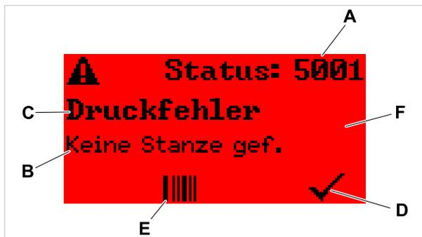
Bild 55: Beispiel für die Darstellung von Statusmeldungen
