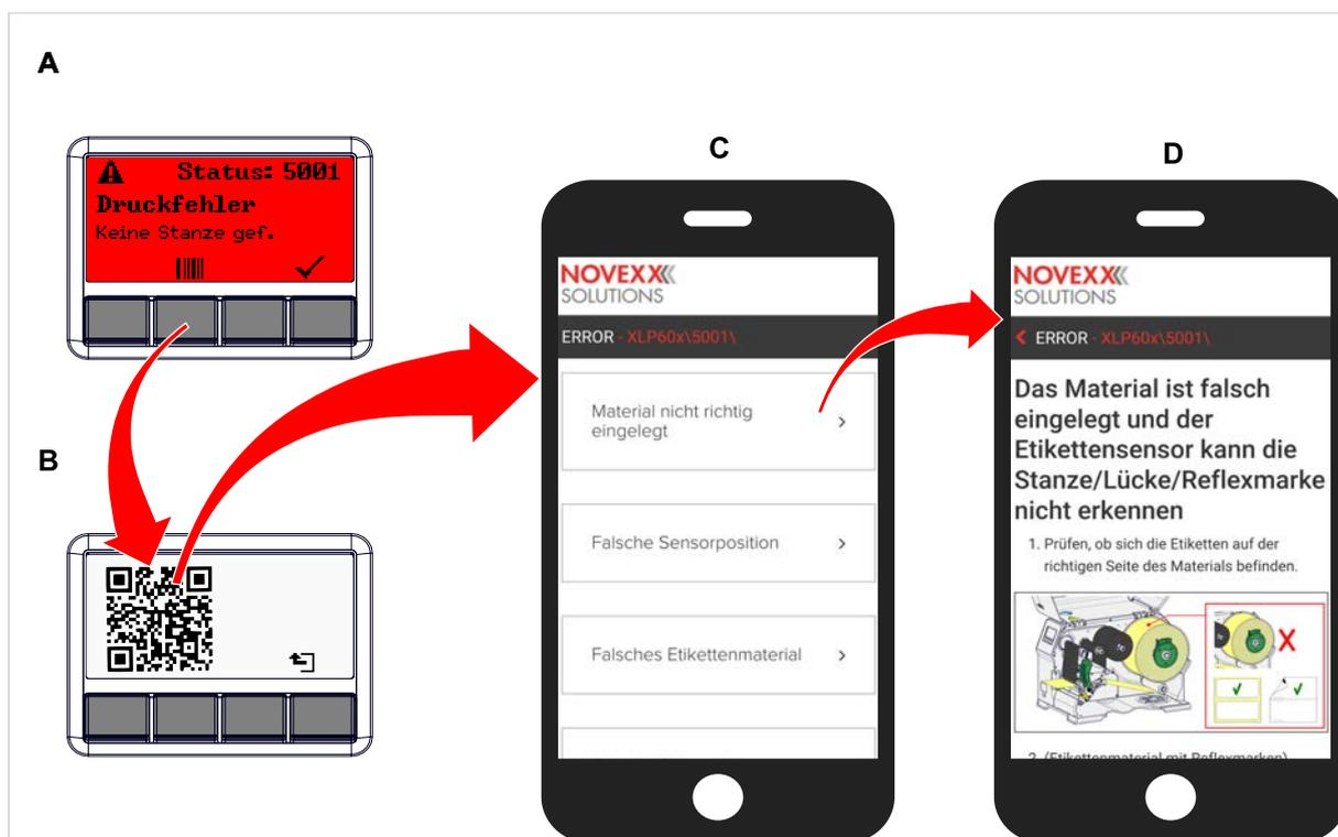
Bild 59: Wenn die Fehlermeldung ein Barcode-Symbol aufweist (A), kann über einen QR-Code (B) eine Anleitung zur Fehlerbehebung (C) auf dem Smartphone aufgerufen werden.
