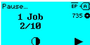
Bild 54: Gestoppter Druckauftrag. Taste 4 drücken, um fortzufahren.
