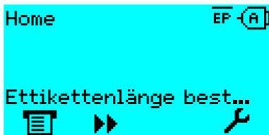
Bild 42: Die Etikettenlänge wird gemessen.
