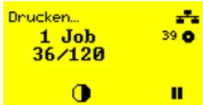
Bild 48: Folienwarnung während eines Druckauftrags: Der Hintergrund ist gelb, das Foliensymbol blinkt.
