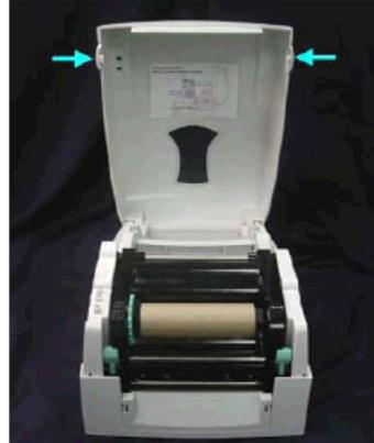
Setzen Sie die Etikettenrolle auf die Abwickelvorrichtung.
