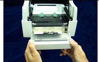
Ziehen Sie die Schrauben fest und schließen Sie die Messereinrichtung.
