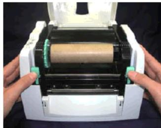
Führen Sie das Etikettenmaterial in beiden Etikettenführungen über die Abreißkante. Richten Sie die Etikettenführung zum Etikettenrand aus.
