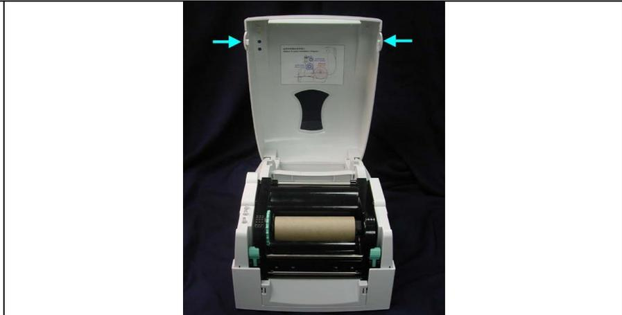
Drücken Sie die Tasten auf der Vorderseite nach innen, um die Abdeckung zu öffnen.
