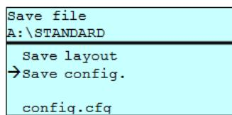
Enregistrer la configuration de module d'impression complète sous le nom sélectionné.
